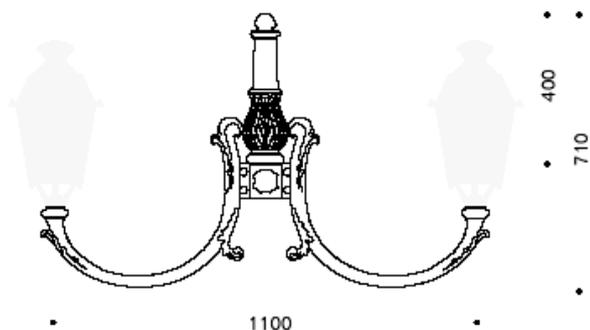
Gruppi cimapalo per il sostegno di corpi illuminanti, per pali in ghisa, formati da elementi in fusione di ghisa, fusione di alluminio e tubolari in acciaio, tipo PN30 della CITTARREDO o similari.
