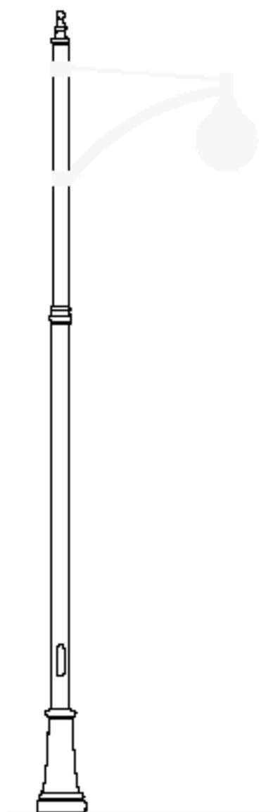
Pali rastremati in ghisa ed acciaio, con altezze da 450 a 600 cm, formati da due tubi, saldati fra loro in corrispondenza della rastremazione. Le parti in ghisa sono le basi, le cime ed i collari. Tipo PISA della CITTARREDO o similari.
