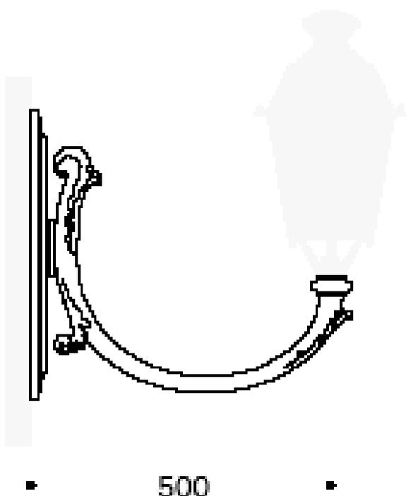
Mensole a muro, per lanterne portate o a sospensione formate da elementi in fusione di ghisa o di alluminio e tubolari in acciaio, tipo MN30 della CITTARREDO o similari.
